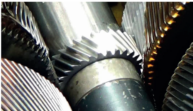
Abb. 3: PM-Laufverzahnung nach dem Verdichtungswalzen [Bild: Profiroll Technologies]
